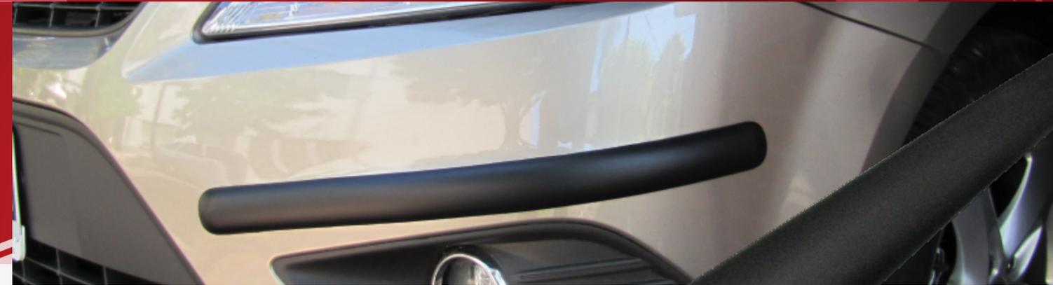
Las molduras protectoras de paragolpes con terminales redondeados son de aplicación directa, no requieren cortes y abarcan una gran cantidad de modelos de automóviles.
