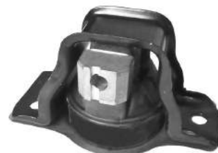
Código: 80176 HIDRAULICO Modelo: MEGANE II Nº Original: 8200549046 Soporte motor derecho hidráulico muela izq. Megane II
