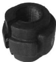
Código: 90064 Modelo: PASSAT 2002 en adelante Nº Original: 4D0.411.327-E Buje barra estabilizadora ø 24 mm
